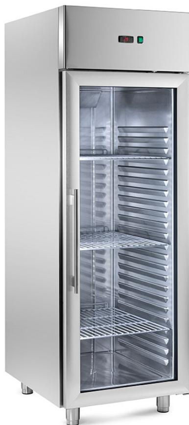
Armadio refrigerato GR in acciaio inox versione con anta in vetro, isolamento spessore 80mm, sbrinamento ed evaporazione condensa automatico, controllo digitale. 600 Lt. luce e chiusura a chiave comprese, Temp. -2/+10°C DIM. MM 690X820X2050 H - GRV250
